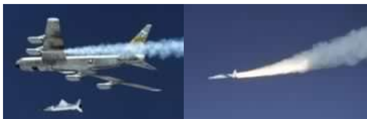
A sinistra X-43 lascia il B52, a destra accensione del razzo Pegasus
